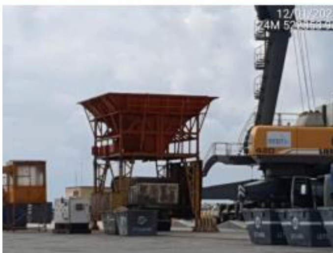
Movimentação de carvão utilizando moega
