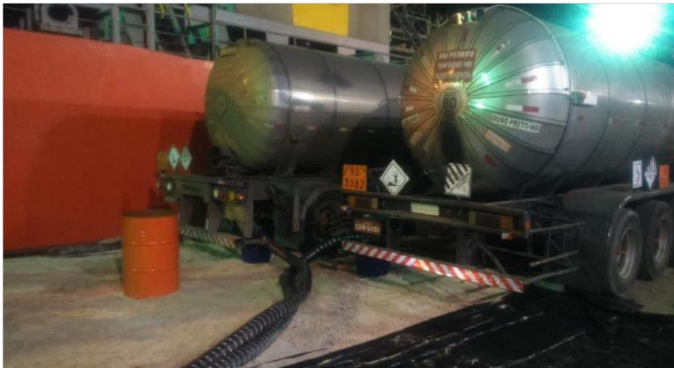
Foto 3: Caminhões estacionados, mangotes conectados e baldes posicionados.
