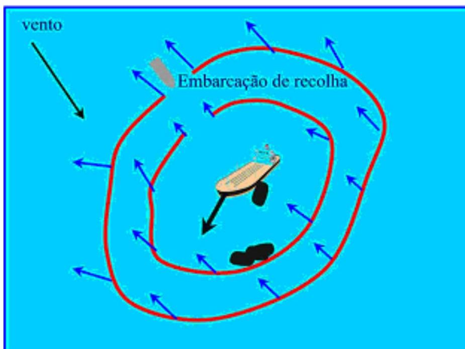
Barreira em forma de círculo com abertura para embarcações
