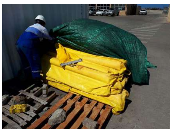
Figura 44 – Barreira de Contenção do tipo Cortina disponível no Porto .
